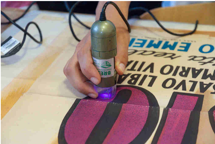
Dino-lite, microscopio digitale 500x analisi a luce visibile a luce ultravioletta e relativi risultati
